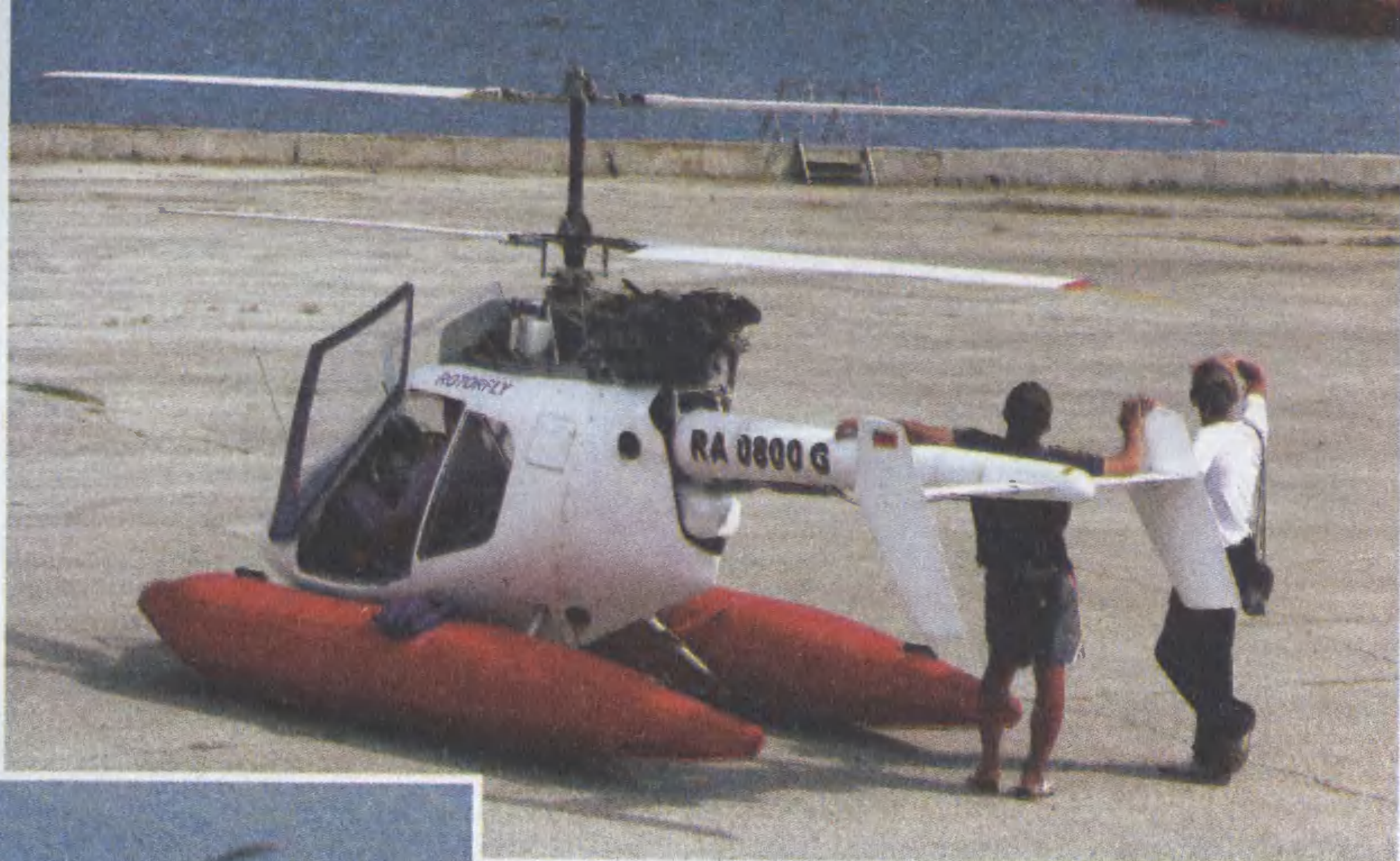
Самый легкий в мире отечественный вертолет соосной схемы Rotorfly, созданный в КБ «Ротор».
